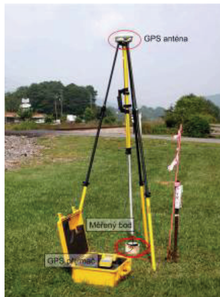
Obrázek 31 GPS anténa pro opakované měření na bodě
