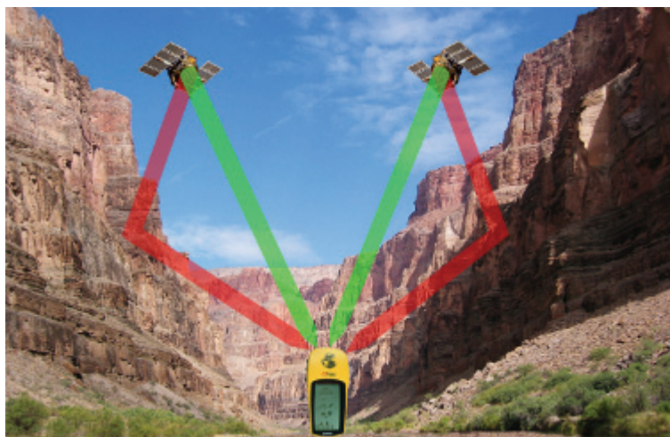
Obrázek 29 Multipath GPS signálu
